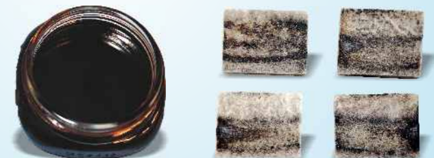
Abb 2: Filzunterlagen der Rill- und Schneidvorrichtung nach dem Einsatz von Turmocut SR 15
