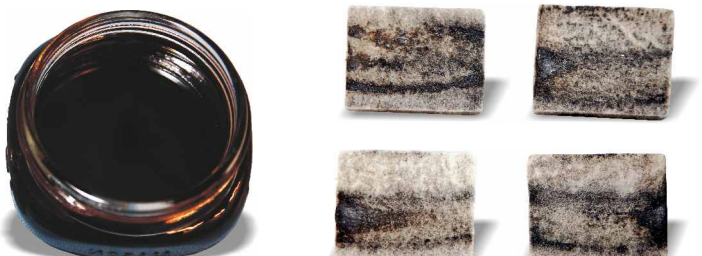
Bild 2: Filzunterlagen der Rill- und Schneidvorrichtung nach dem Einsatz von Turmocut SR 15
